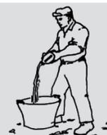
2. Die erhaltene Lösung (Wasser + Geco Zusatz) in die leere Betonmischmaschine gießen.
