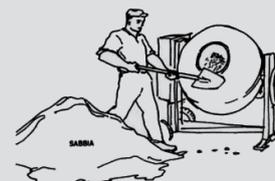
4. 50 kg hydraulischen Bindemittel in die Betonmischmaschine geben. *Empfohlene Dosierung:* 25 kg Zement + 25 kg Kalk. Hinweis: Geco Zusatz kann auch für Mörtel verwendet werden, die nur mit Zement oder nur mit Kalk hergestellt werden.
