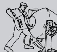
3. Die Betonmischmaschine in Bewegung setzen und ca. 150 L gewaschenen Sand hinzufügen und weiter mischen.
