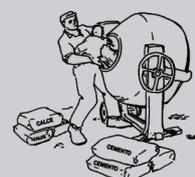
5. Mindestens 10 Minuten mischen. Hinweis: Die Einhaltung der Mischzeit ist entscheidend für die Herstellung eines optimalen und effektiven entfeuchtenden Mörtels.
